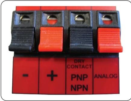
Les capteurs PNP/NPN, contact sec 2 fils et les capteurs analogiques peuvent être testés en les raccordant de manière appropriée aux borniers.
